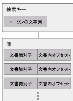
図 1 N-gram 法の転置インデックスの構造 Fig. 1 Structure of Inverted Index of N-gram
